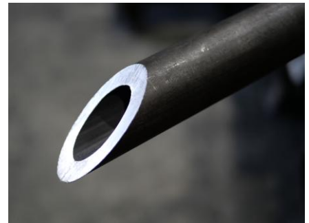
鉄パイプ 斜め切断(メタルソー)
