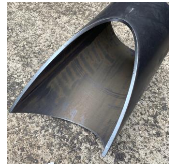
鉄パイプ 切断事例 (プラズマ)
