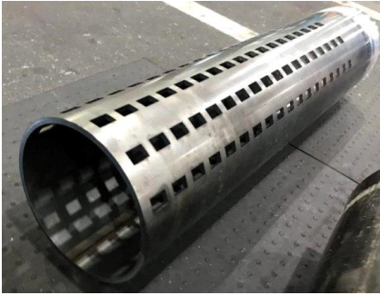
レーザー穴あけ加工
