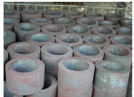
鋼管 切断+熱処理迄
