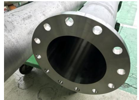
フランジ溶接+内面研磨
