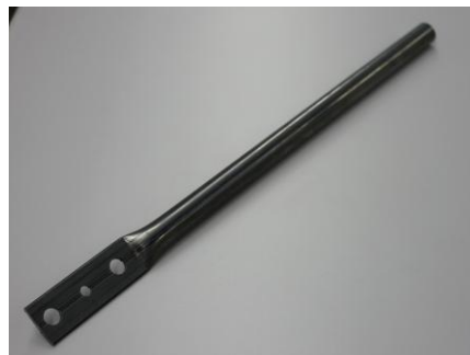
つぶし 穴明け加工(専用金型使用)
