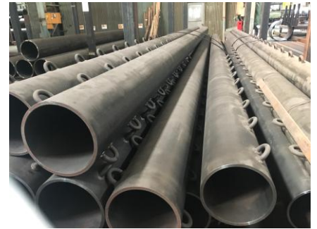
鋼管 金具溶接
