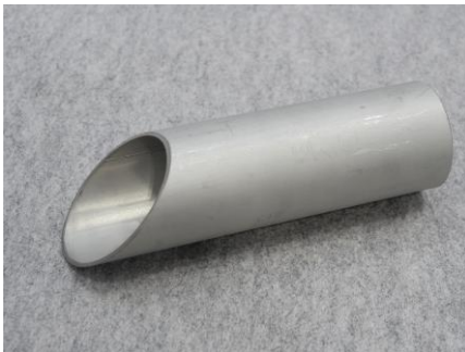
ステンレスパイプ 斜め切断
