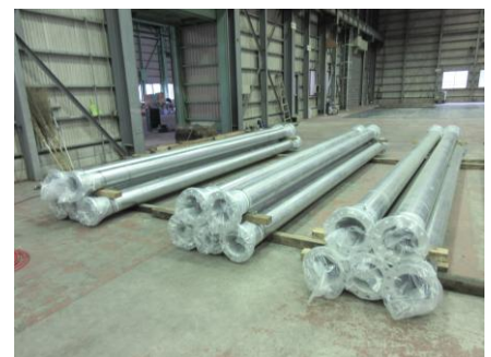
鋼管フランジ溶接+めっき加工
