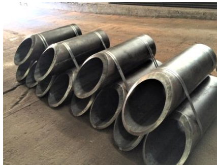
鉄パイプ斜め切断+開先 (ガス)
