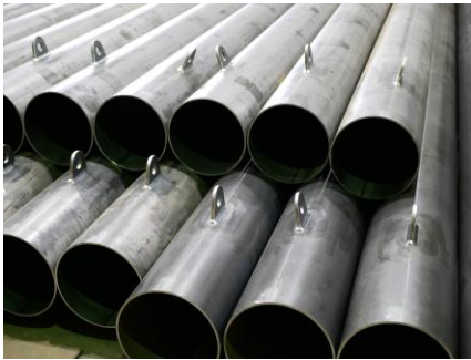
吊り金具溶接
