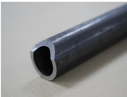
パイプ 多角切断 (メタルソー)
