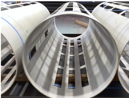
ステンレスパイプ レーザー切断(φ508.0)
