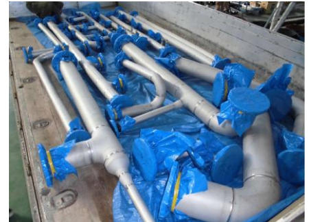
各種配管加工
