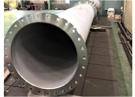
フランジ・吊り金具溶接 (SUS800A)
