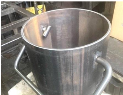
鋼管加工（取っ手取り付け）
