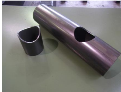
鉄パイプ 切断事例 (レーザー)
