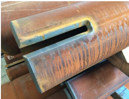
鉄パイプ スリット加工 (溶断)
