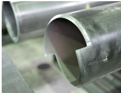
鉄パイプ 切断事例 (プラズマ)
