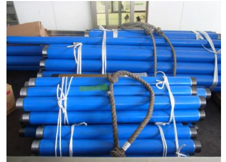
被覆鋼管 ネジ切加工
