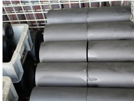
鋼管塗装 (下塗り)
