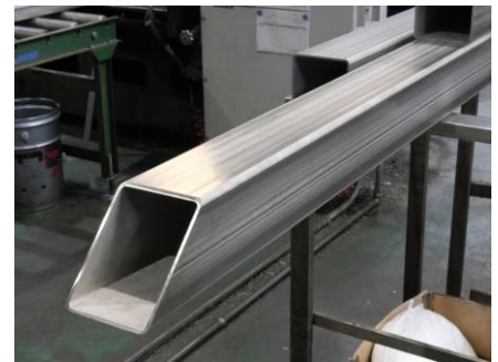
SUS大型角パイプ斜め切断
