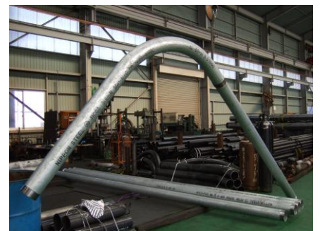
ネジ+曲げ加工 (鉄パイプ)
