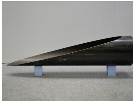
鉄パイプ 斜め切断 (φ216.3鋭角)
