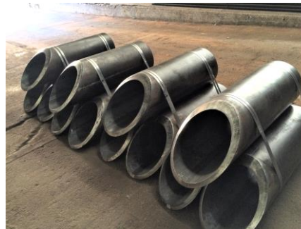
鉄パイプ斜め切断+開先 (ガス)
