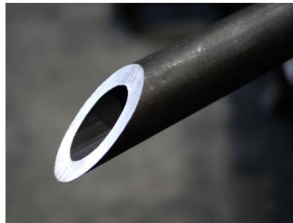
鉄パイプ 斜め切断(メタルソー)
