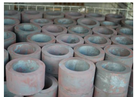
鋼管 切断+熱処理迄
