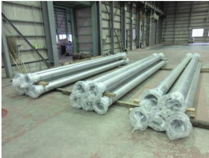
鋼管フランジ溶接+めっき
