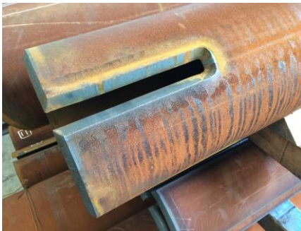
鉄パイプ スリット加工 (溶断)
