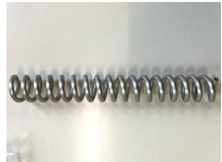
SUS小径管を直管で溶接後コイル巻
