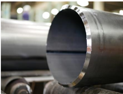
鋼管 ベベル加工
