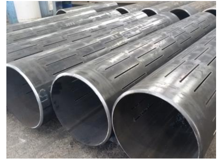
鋼管 ストレーナー加工
