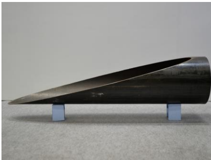
鉄パイプ 斜め切断 (φ216.3鋭角)
