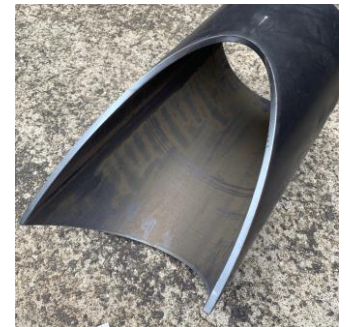
鉄パイプ 切断事例 (プラズマ)
