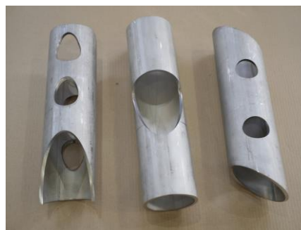
ステンレスパイプ レーザー切断
