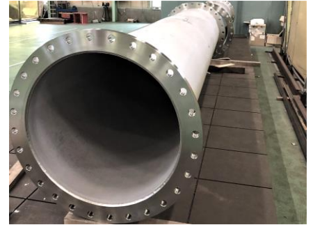
フランジ・吊り金具溶接 (SUS800A)
