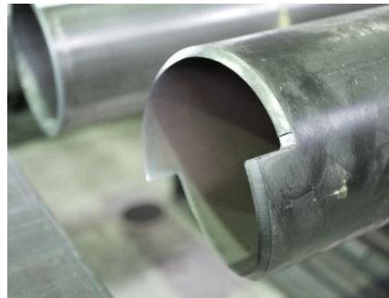
鉄パイプ 切断事例 (プラズマ)
