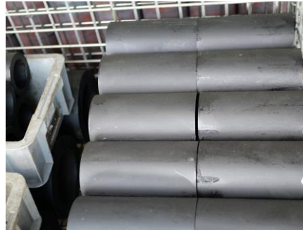
鋼管塗装 (下塗り)
