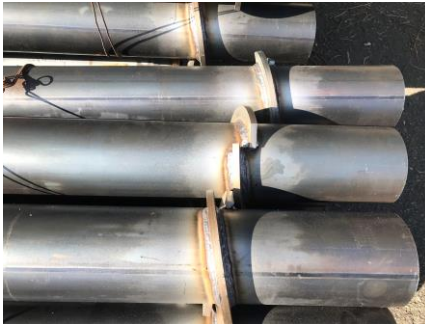
鋼管への羽根付け
