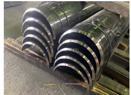
鉄パイプ 半割切断
