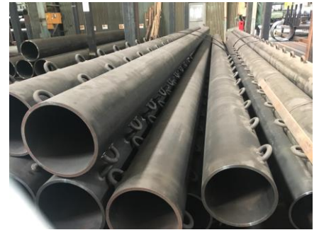
鋼管 金具溶接
