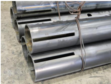
鉄パイプ 切断事例 (プラズマ)
