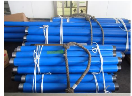
被覆鋼管 ネジ切加工
