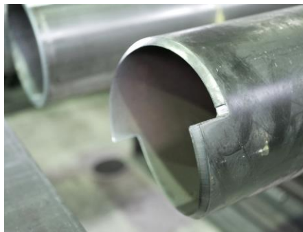
鉄パイプ 切断事例 (プラズマ)
