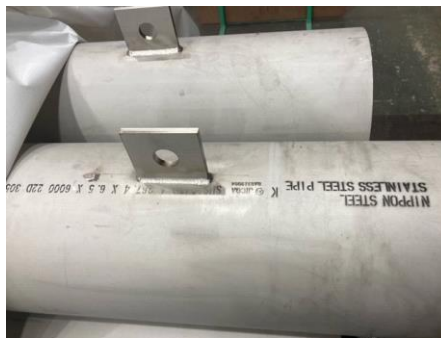
吊り金具溶接（ステンレス）
