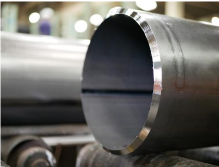
鋼管 ベベル加工
