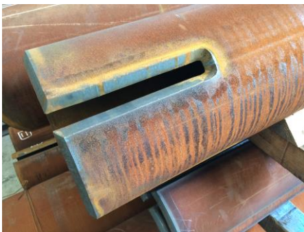
鉄パイプ スリット加工 (溶断)
