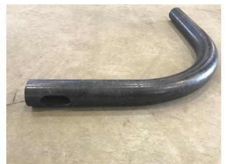
曲げパイプ穴明け
