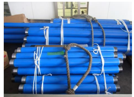
被覆鋼管 ネジ切加工
