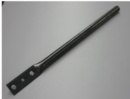
つぶし 穴明け加工（専用金型）
