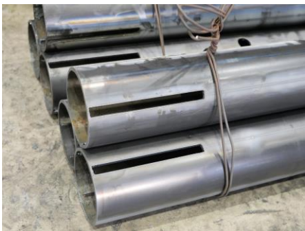
鉄パイプ 切断事例 (プラズマ)
