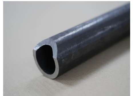
パイプ 多角切断 (メタルソー)
