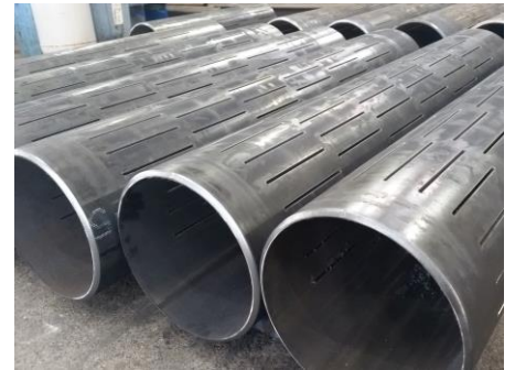
鋼管 ストレーナー加工
