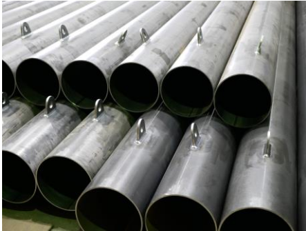
吊り金具溶接
