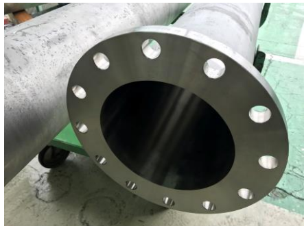
フランジ溶接+内面研磨
