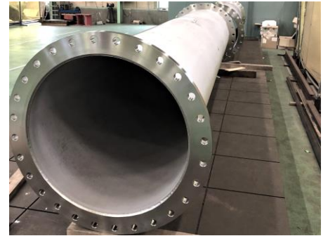
フランジ・吊り金具溶接 (SUS800A)
