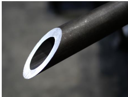
鉄パイプ 斜め切断(メタルソー)
