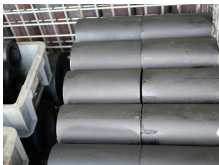
鋼管塗装（下塗り）
