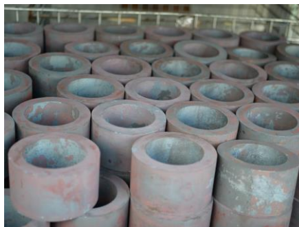
鋼管 切断+熱処理迄
