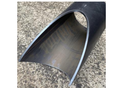
鉄パイプ 切断事例 (プラズマ)
