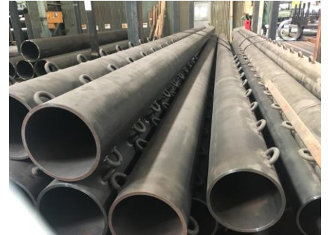
鋼管 金具溶接
