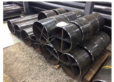
切断・開先・溶接事例
