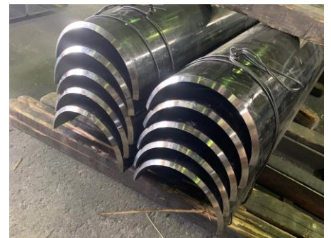
鉄パイプ 半割切断
