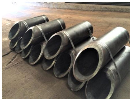
鉄パイプ斜め切断+開先 (ガス)
