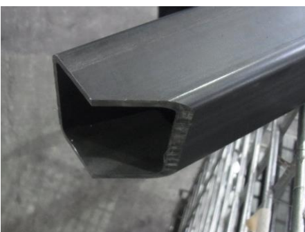
鉄角パイプ 多角切断 (メタルソー)
