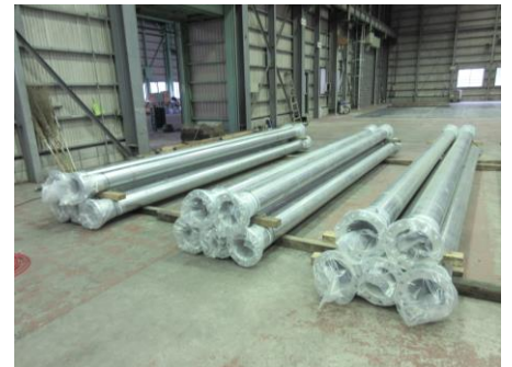
鋼管フランジ溶接+めっき
